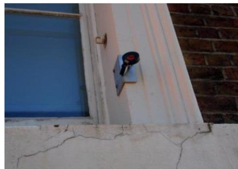
圖 3.1-2 監測 Pattington 車站變位之雷射反射鏡
