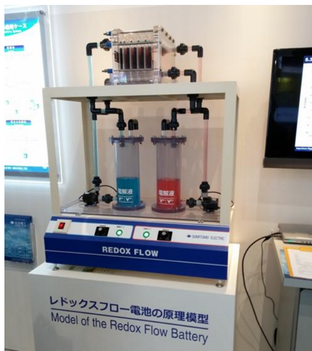
圖 18 全鈦液流電池原理模型-住友電工
