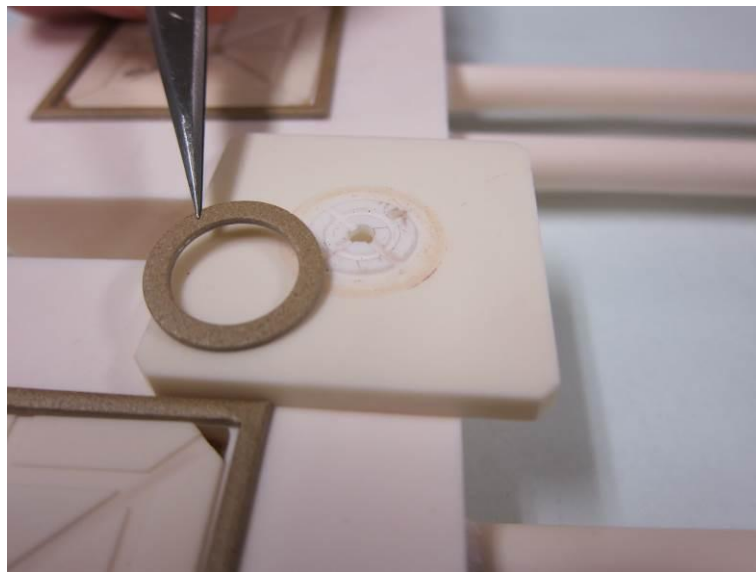
圖 12 SOFC 單元電池量測夾具擴充式夾具與組件
