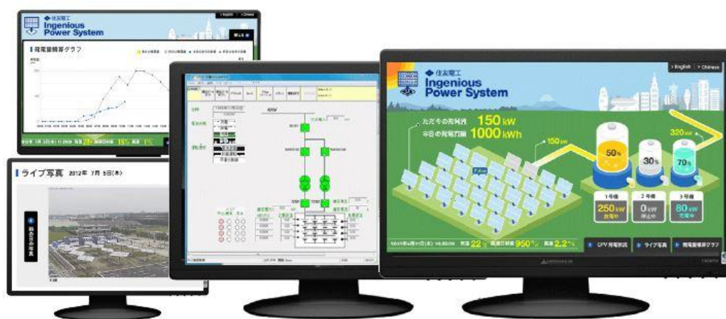
圖 6 橫濱工廠大型發電與儲能能量管理系統[3]
