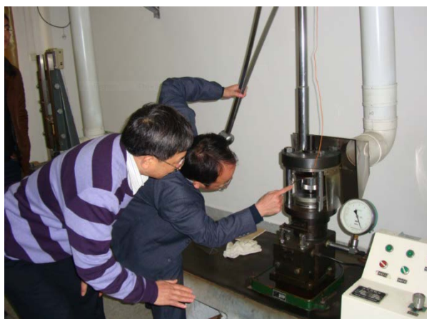
湖南出入境檢驗檢疫局 烟花爆竹檢測中心摩差力測試
