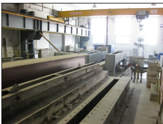
圖 18 水平構件耐火測試設備
