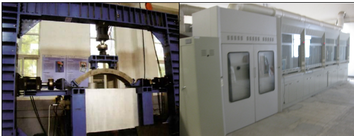
圖 20 隧道及地下工程耐火測試設備
