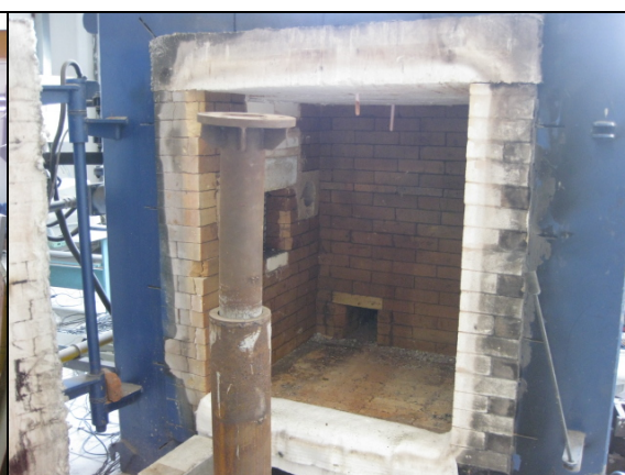
圖 19 小型節耐火構測試設備
