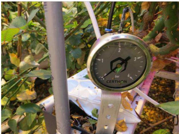
圖27、為確保管路兩端壓力一致，圖為溫室內用來監測灌溉管路壓力的感測器。
