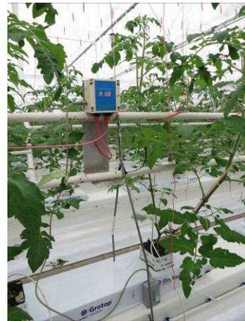
圖26、溫室內用來監測介質溫度、EC及水分含量感測器
