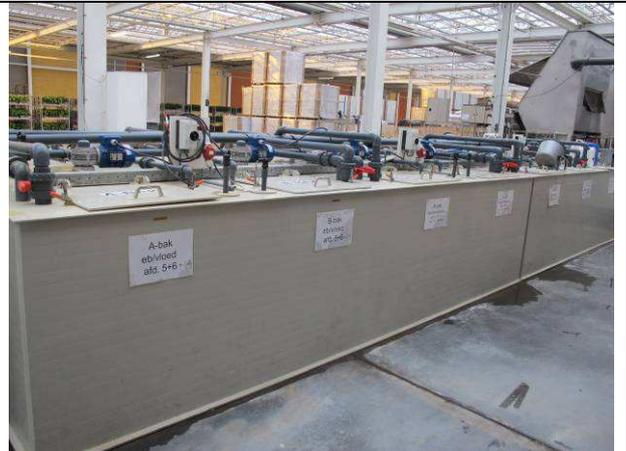
圖20、溫室中的養液混合槽，依照設定比例及濃度混合後進行滴灌。
