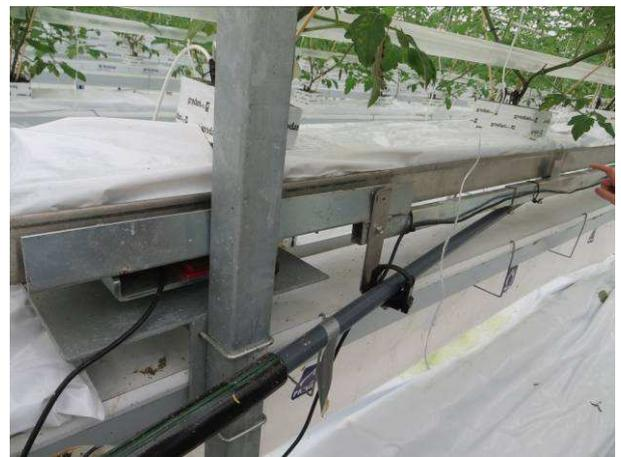
圖28、利用重量原理，監測介質水分含量的感測器。
