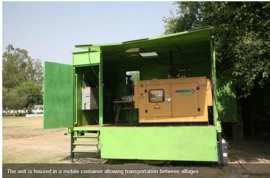
圖 71、歐洲生質能源研究所(EBRI)計畫團隊研發移動式 Pyroformer™
