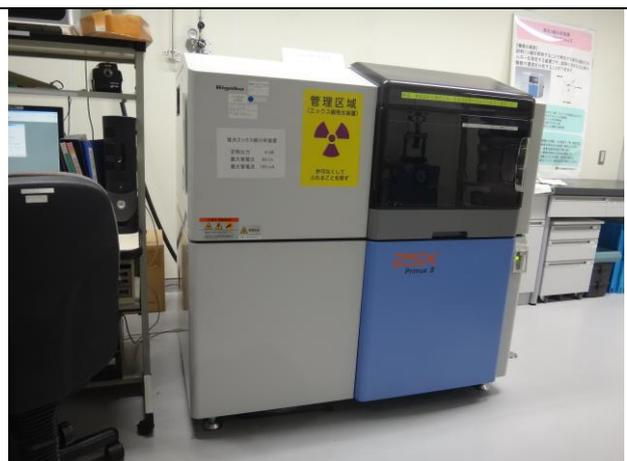
圖三十二、由植松洋子博士介紹日本食品器具容器及包裝管理法規及衛生標準，並參觀實驗室。圖為螢光 X 線分析儀，可以分析金屬食品容器之金屬成分及比例。
