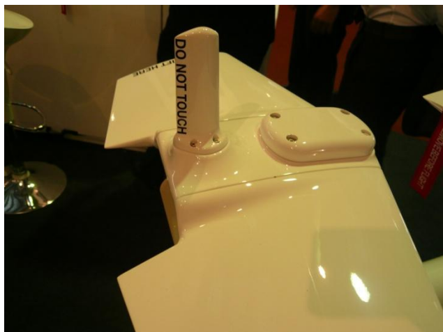
圖十七、S-100 尾翼上之傳輸天線
