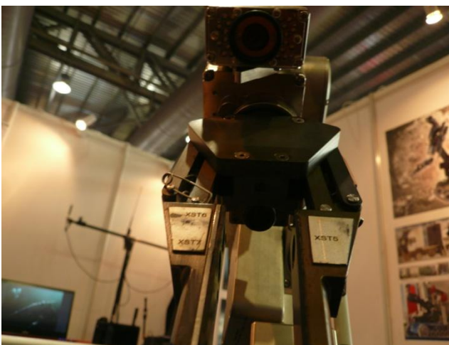
圖 21、UGV 工作手臂後端攝影機
