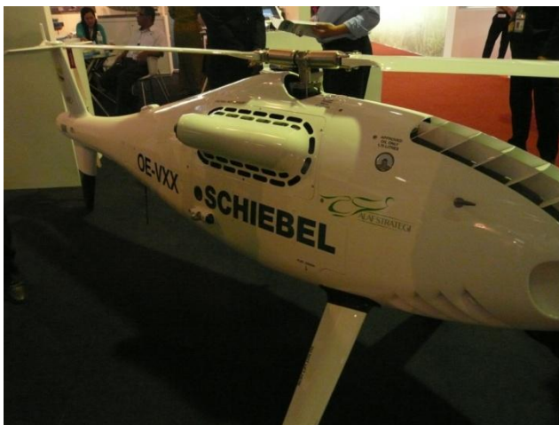
圖十三、S-100 側視引擎排氣出口
