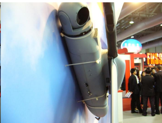
圖十六、Skyblade III 任務酬載及尾端天線
