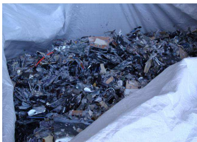
圖 35 經異物移除系統離心後的金屬物質，回收金屬
