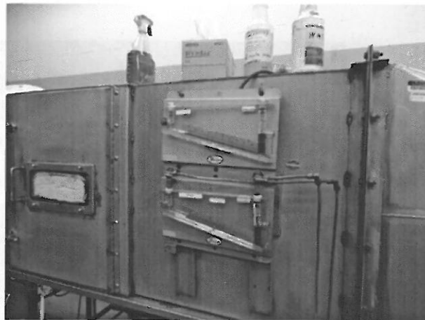
圖 12 廢氣採樣設備
