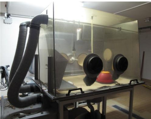
圖 7. 自行設計訂作的飼養實驗動物之獨立操作台
