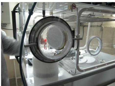
圖 25.隔離箱之物品傳遞孔
