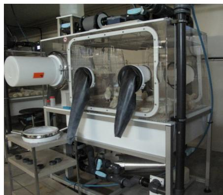
圖 24.用隔離箱進行具感染性之試驗
