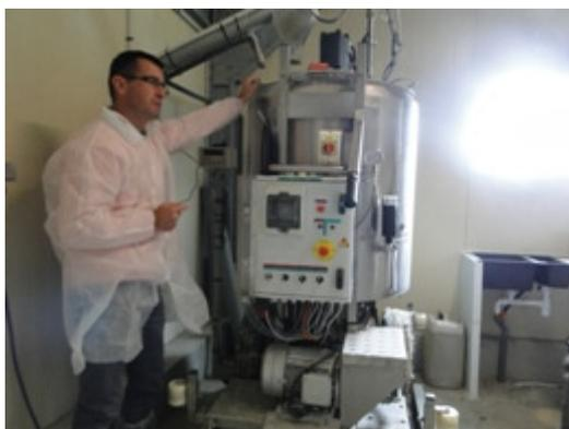
圖 45. 自動化填灌機，使用前將飼糧與水進行充分混和，設定灌食量後即可推至鴨舍內進行灌食作業
