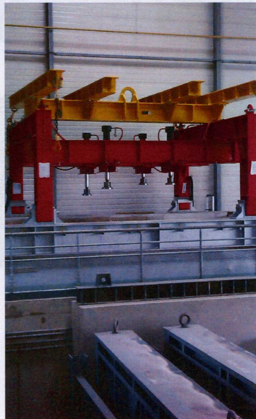
液壓加載設備鋼構架
