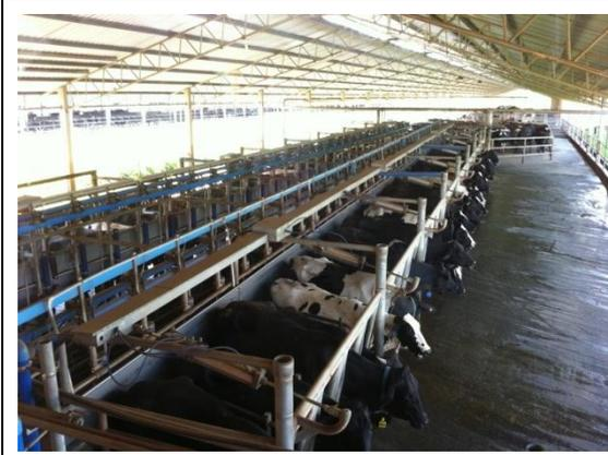
圖3、乳牛真空式搾乳設備
