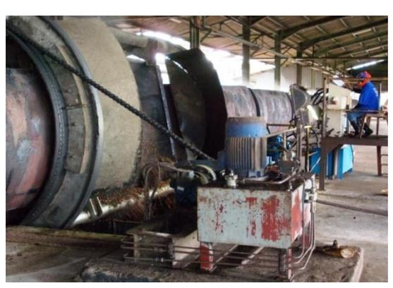
圖36、完成蒸煮的輸送列車正旋轉卸料
