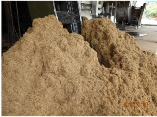
圖45、殘渣可作發電機鍋爐燃料或建材材料
