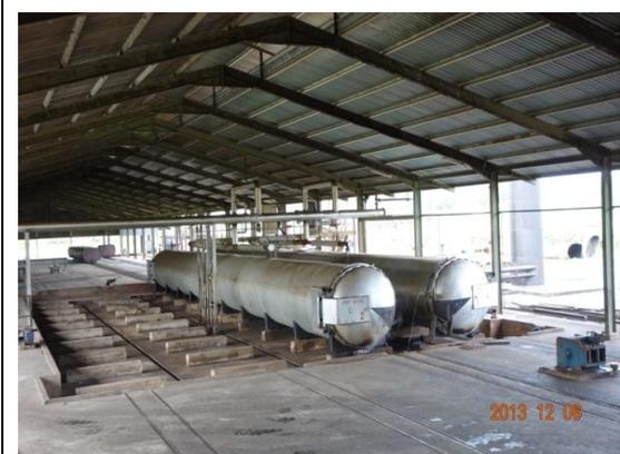
圖35、高壓蒸煮槽(每個容量60噸)
