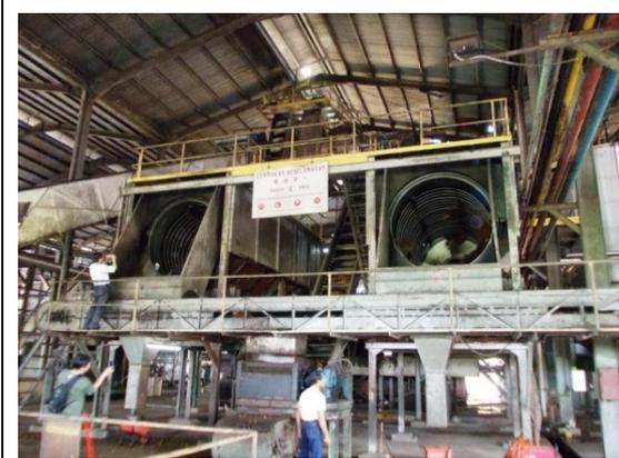
圖37、旋轉離心脫粒桶(照片上方)
