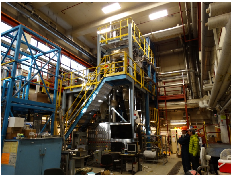
圖 3：UBC 大學 Pulp & Paper Centre 的雙床氣化系統
