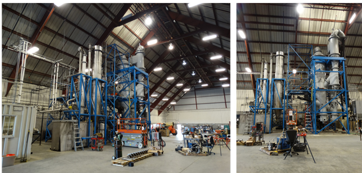
圖 12：West Biofuels LLC 的雙床式生質物流體化氣化模場系統
