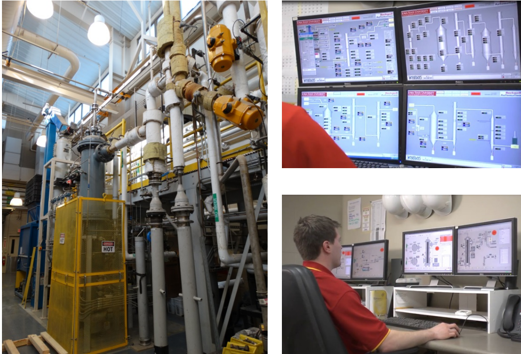
圖 7：ISU 的 20 kg/h 生質物流體化床氣化模場與監控系統
