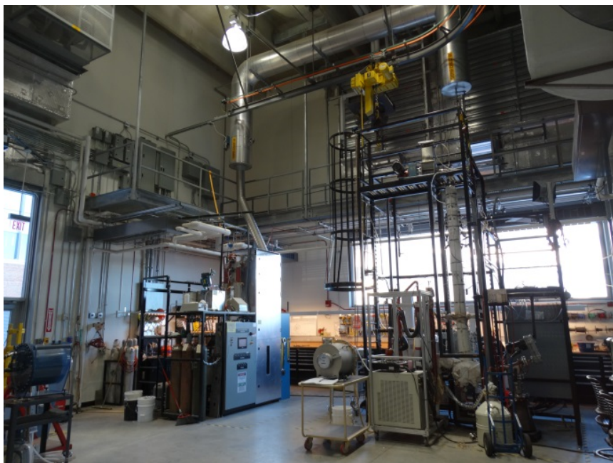
圖 10：ISU 的裂解油氣化系統(左)與自由落體熱模系統(右)
