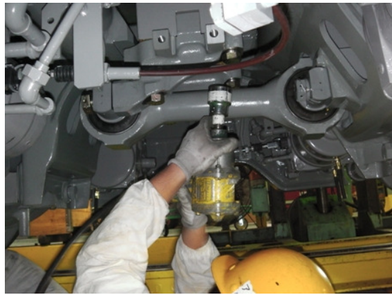
圖72 轉向架中心盤安裝
