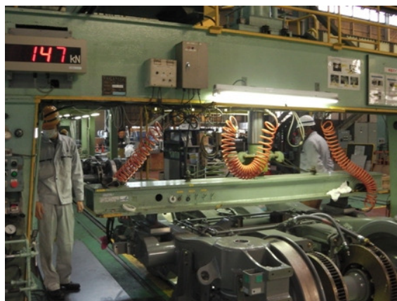
圖63 轉向架荷重機施壓147KN
