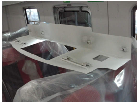
圖34 SI設備內裝板安裝
