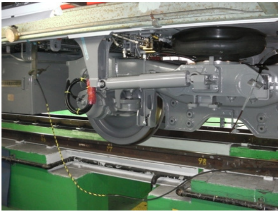
圖85 TEP2033車測試前施行接地作業
