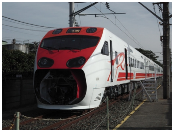
圖104 第16編組整備線送電検査
