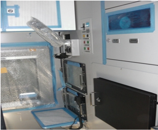
圖29 TED車車長室設備電裝作業
