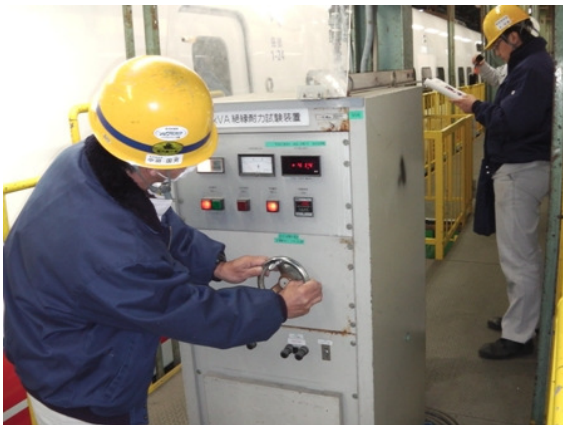
圖87 耐壓耐力試驗機加壓中
