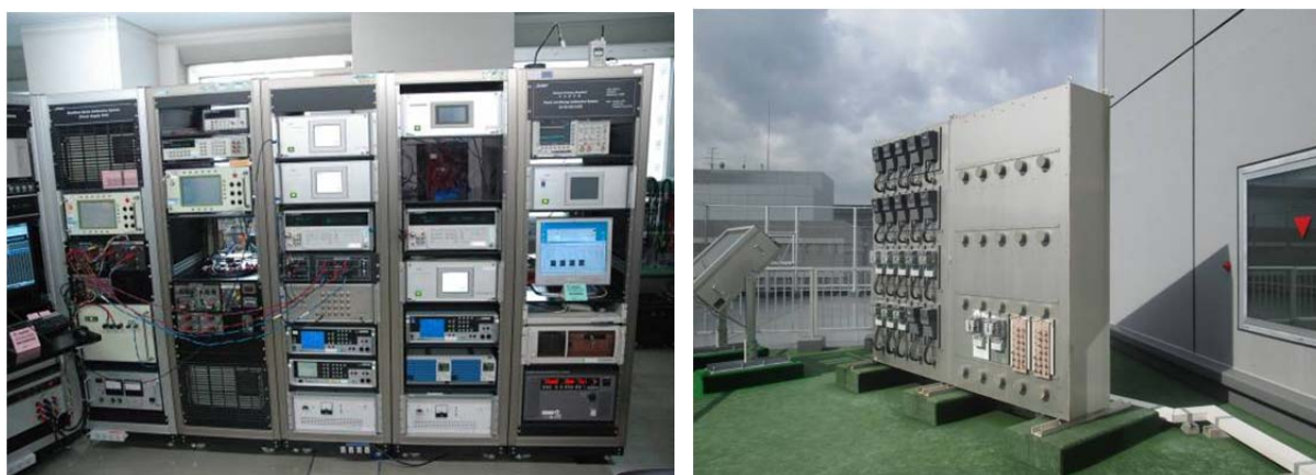
圖 19 JEMIC 電能標準原級設備及電度表太陽光照射試驗(資料來源：現場拍攝)
