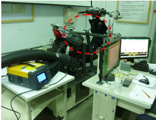
第三圖 實車於馬力測試機上之測試情形
