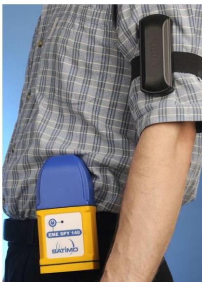
圖 4 監測個人暴露電磁波量之簡單接收記錄儀器
