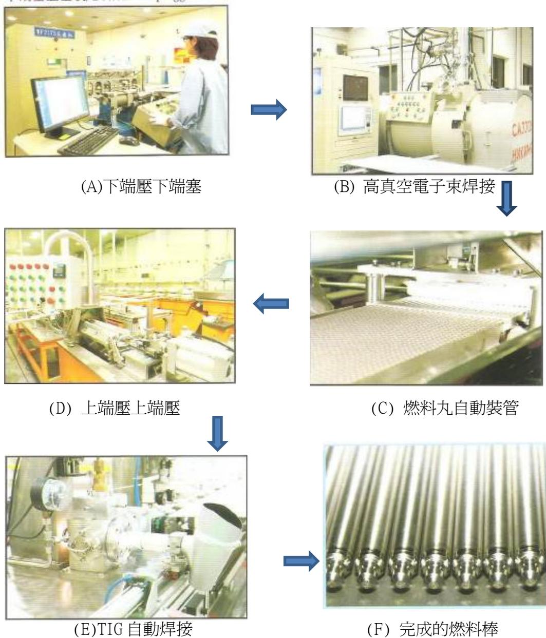
圖 22. 燃料棒製造流程
