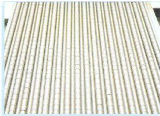
圖 20. 完成檢測的  $\text{UO}_2$  燃料丸
