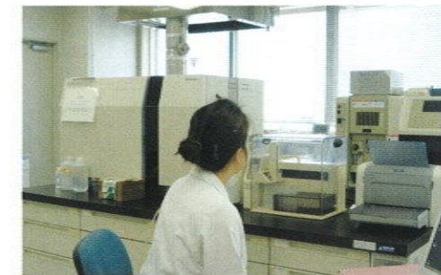
誘導結合プラズマ質量分析計(ICP-MS)による肥料及び肥料原材料の金属元素の分析
