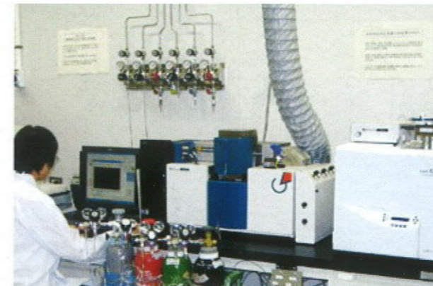
安定同位体比測定装置による分析
