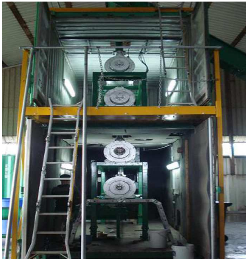
圖 11、處理戴奧辛污染土壤之球磨機
