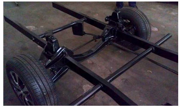
圖 4 印尼電動車底盤製作
