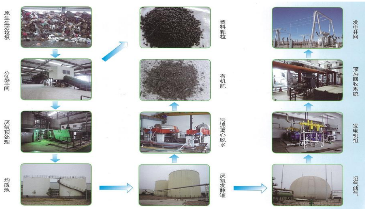
圖 9 有機可分解物厭氧發酵處理流程(資料來源:綠茵提供資料)
