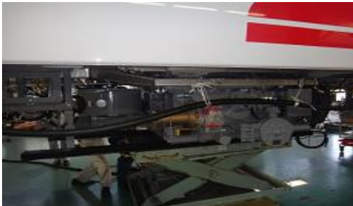
圖43主變壓器安裝
