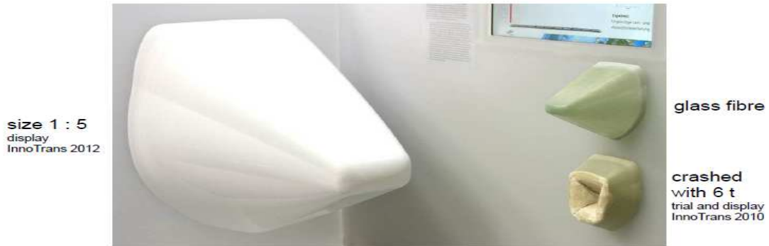
圖87.以1:5縮小比例尺模擬之機車頭尖端(如上圖左方)
