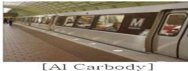
圖128.製造列車生態材料之採用(列車本體使用更輕更環保之鋁合金)
