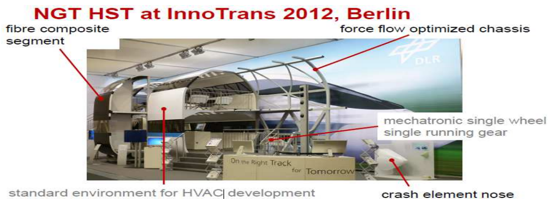
圖88.2012年在InnoTrans,Berlin展出之NGT超高速旅客列車內部構造，包括：最佳化流線型車體骨幹、機電整合之單一輪軸、降低衝撞力之機車頭尖端、符合HVAC之冷暖空調系統
