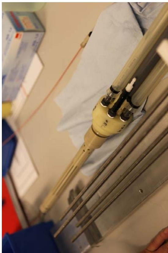
圖 13 附冷卻套的藍寶石管柱
