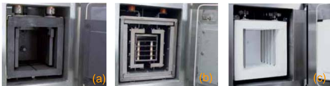
圖 6. 超高溫高溫燒結爐的元件，(a) 石墨加熱腔體；(b) 鉬/鎢加熱腔體；(c) 陶磁纖維隔熱材料。
