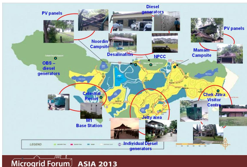
圖 7 Pulau Ubin 電力系統架構
