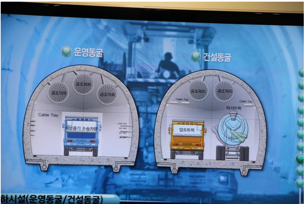
圖 3、韓國月城低放射性廢棄物處置場隧道功能示意圖
