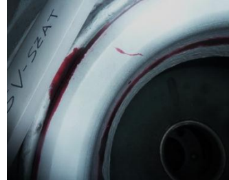
MSV 閥座 PT 檢測有一 35 mm 長之線型指示與 2010 年大修報告相同
