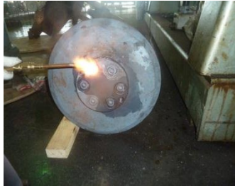
MSV 閥座 PT 檢測有一 35 mm 長之線型指示與 2010 年大修報告相同
