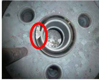
MSV 閥座 PT 檢測有一 35 mm 長之線型指示與 2010 年大修報告相同
