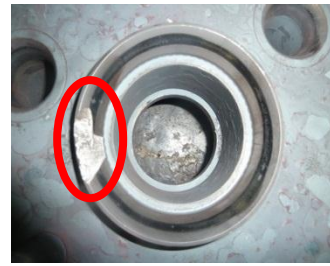
MSV 閥座 PT 檢測有一 35 mm 長之線型指示與 2010 年大修報告相同
