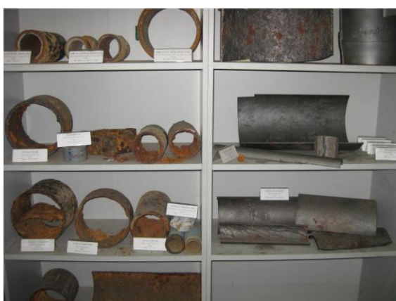
(各種管線經長時間後生鏽情形)
