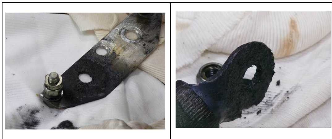
圖 1 及圖 2 T 相內部有載切換開關之選擇器 T6 接頭熔損圖
