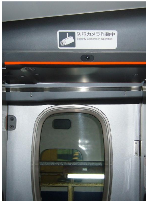
圖 46 N700A 車廂玄關裝設 CCTV
