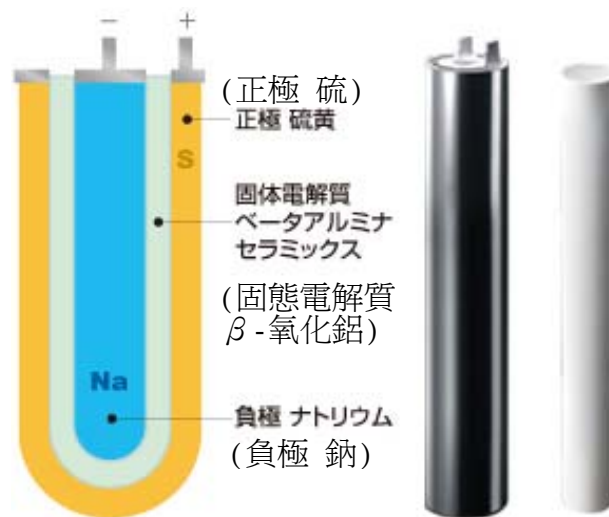
圖 3.15. 日本 NGK 的 NAS 電池單電池結構
