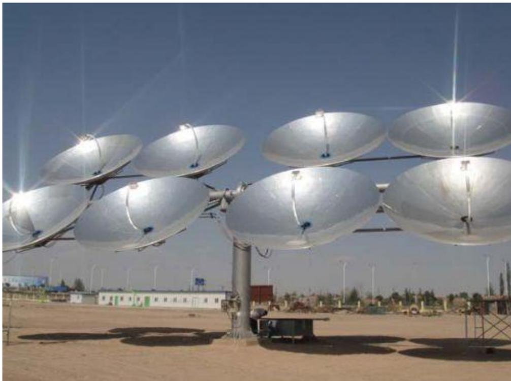
圖 8 聚光太陽能 (CPV) 電熱聯產系統
