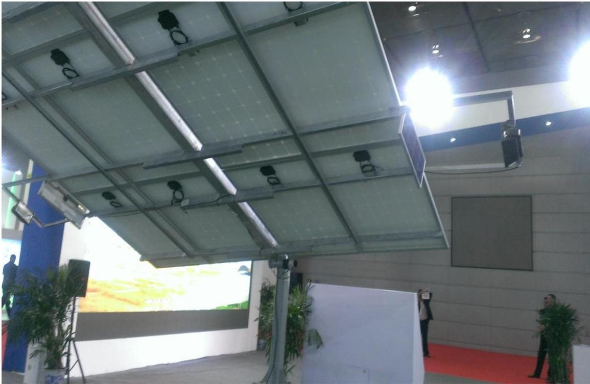
圖 3 振發新能源開發的單軸太陽光追蹤器
