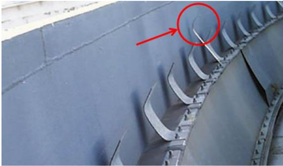
圖 15 在密封圈上之分流器與槽壁未緊密接觸
