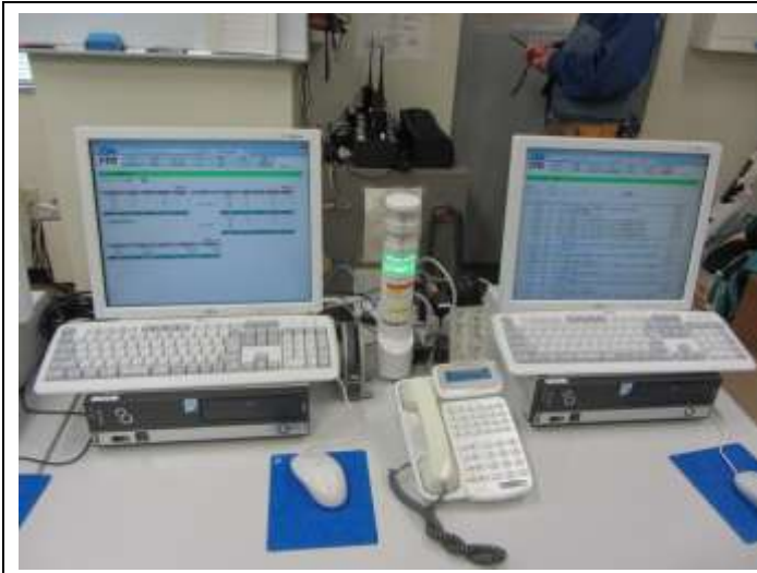
中央控制室 – 灌裝即時監控系統，可即時回饋灌裝泵島訊息
