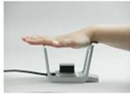
(非接觸性感應器掃描手掌靜脈影像) 取得靜脈近紅外線影像 手掌靜脈儲存樣板
