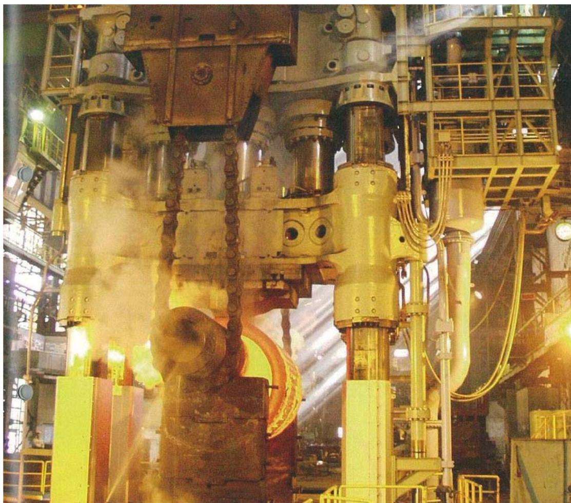
圖 1-3: 14000t 反應器鍛造壓延機
