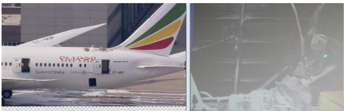
圖 9 某架 787 型機因 ELT 電池著火導致客艙冒煙及著火的事故
