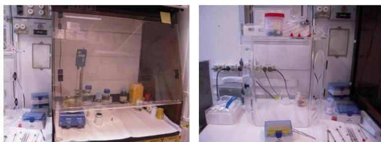
圖 16.  $^3\text{H}$  標幟藥物作業區，抽氣罩具備 HEPA filter
