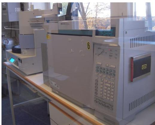
圖 9. KI PET Center 使用的 Head-Space Agilent GC 6890，分析藥物殘留溶劑
