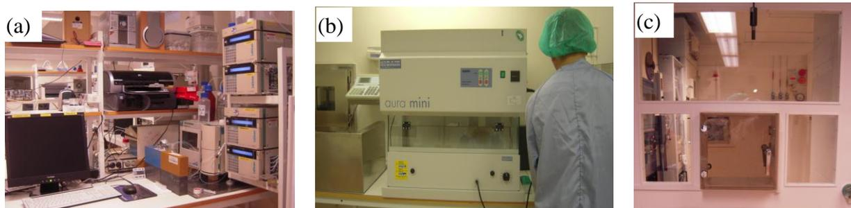
圖 8.  $^{11}\text{C}$ 、 $^{18}\text{F}$  標幟 PET 藥物品管分析：(a)HPLC 純度及(b)放射活度測定 (c)傳送窗口
