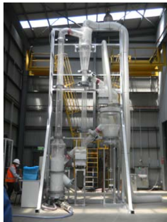
照片 6 氧化方式解離煤礦排風坑中之甲烷氣體先導型試驗設施
