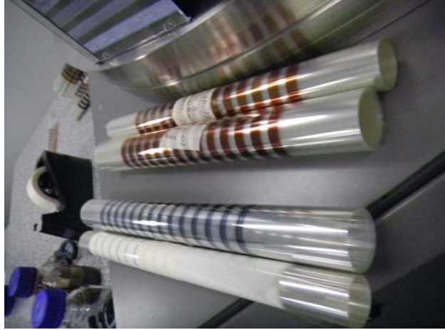
照片 7-8 澳洲新堡能礦資源研究所所發展可捲式印刷太陽能發電基材設備與成品
