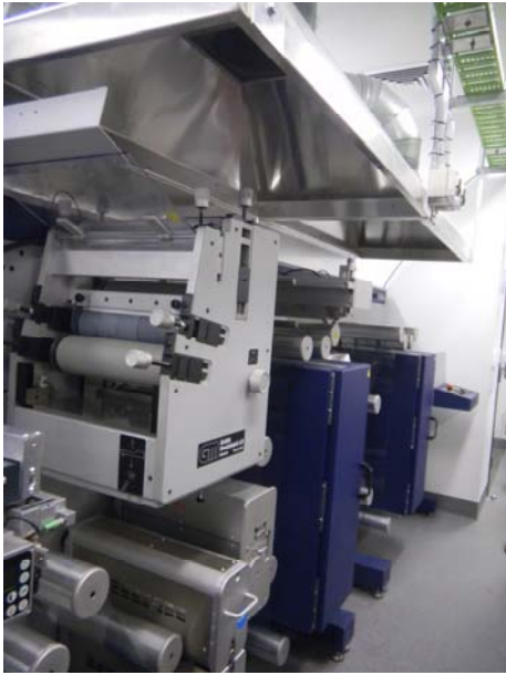
照片 7-8 澳洲新堡能礦資源研究所所發展可捲式印刷太陽能發電基材設備與成品
