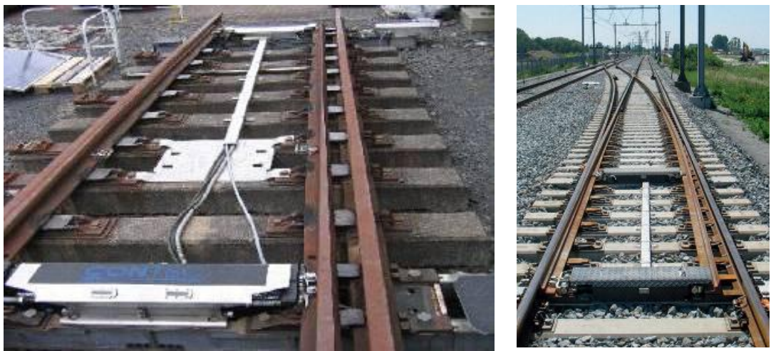
圖 3 單一馬達可透過油管推動一個以上的驅動、鎖錠和偵測單元模組
