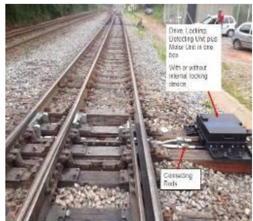
圖 2 油壓式電動轉轍器整合架構
