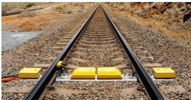
圖 13 光學熱影像偵測模組被安裝於特製鋼枕木
