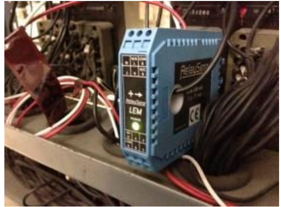
圖 80、使用比流器監控繼電器聯鎖
