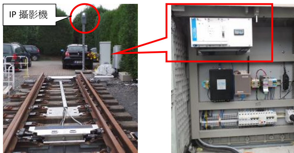
圖 5 用 IP 攝影機及遠端數據監控模組，透過網際網路直接監控並紀錄其驗證情形
