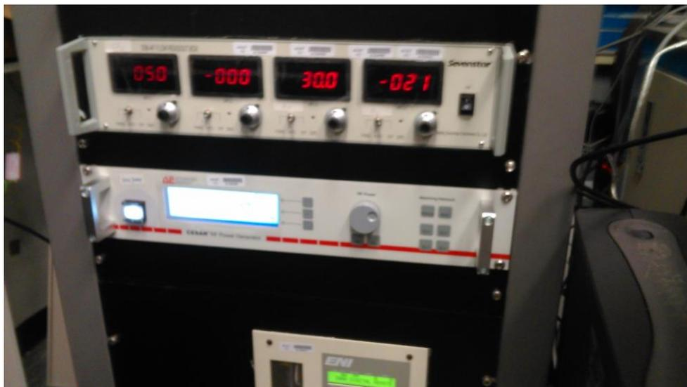
圖六、HKUST 自行組裝 DRIE 儀器—控制系統 II。
