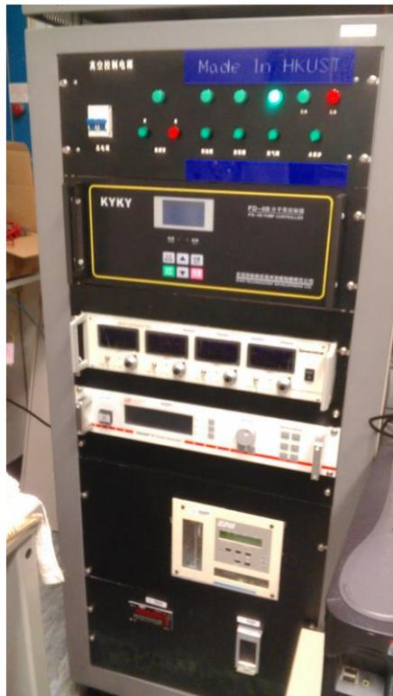
圖五、HKUST 自行組裝 DRIE 儀器—控制系統 I。
