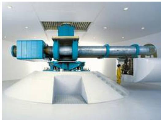
圖 49 竹中技術研究所的離心模型實驗室
