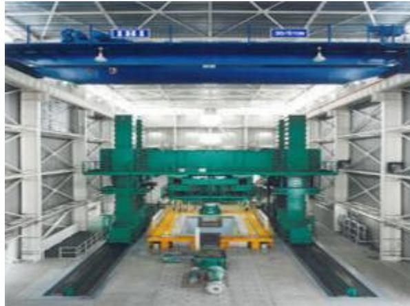
圖 48 竹中技術研究所加載設備的防火實驗室
