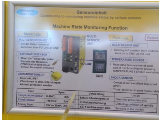
圖 2-16 機器運轉狀態監控技術
