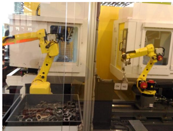
圖 2-6 負責卸料件機器人與檢測機器人之整合
