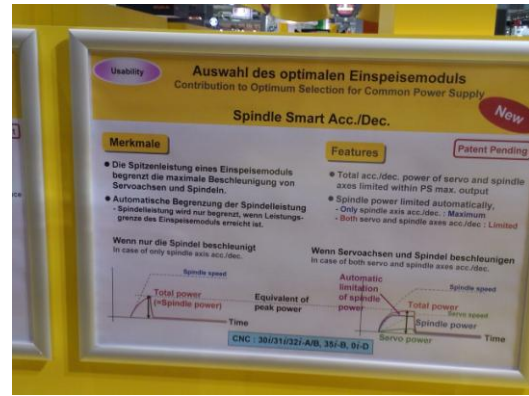
圖 2-17 切削主軸功率狀態監控技術
