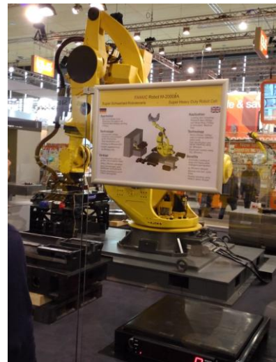
圖 2-8 具視覺辨別能力之工件檢測機器人
