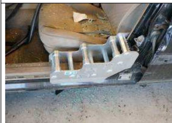
圖 34-17 設置止滑塊，以利稍後架設推頂桿。
