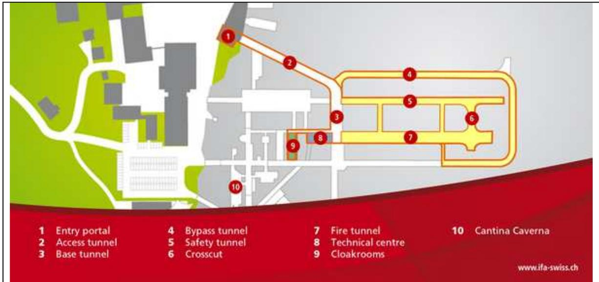
圖 9 龍疆鎮隧道訓練設施平面配置圖。
