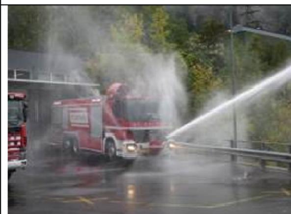
圖 16-5 特殊隧道車輛以水霧保護車身並同時噴射水柱。
