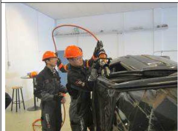
圖 34-23 剪斷上方 B 柱。
