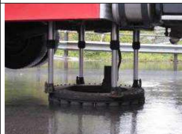
圖 16-7 特殊隧道車輛底部油壓裝置。
