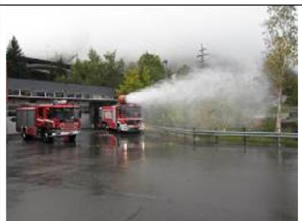
圖 16-6 特殊隧道車輛車頂排煙機噴射水霧情形。
