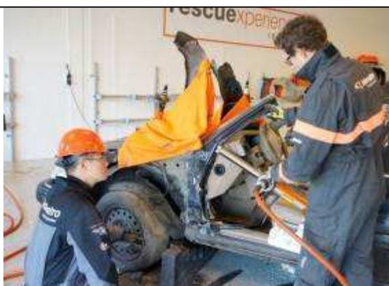
圖 34-18 使用推頂桿製造脫困空間。
