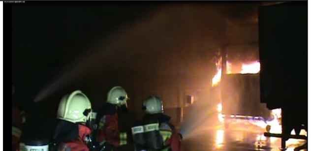
圖 17-6 由隧道兩側部署水線，作包夾。
