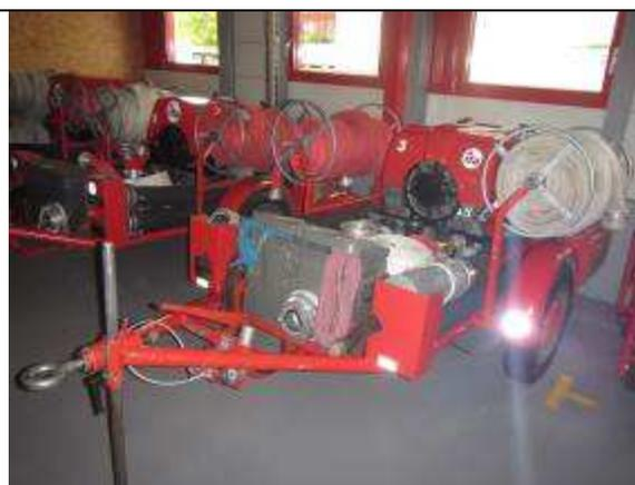
圖 22-4 器材放置車架，內放置滅火所需基本裝備，可被拖拉。
