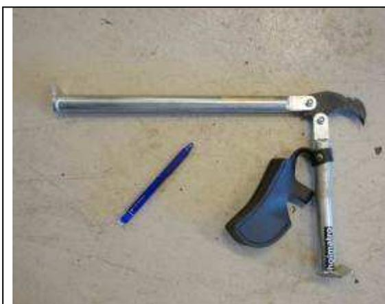
圖 34-1 固定器材附屬裝備用於打孔。
