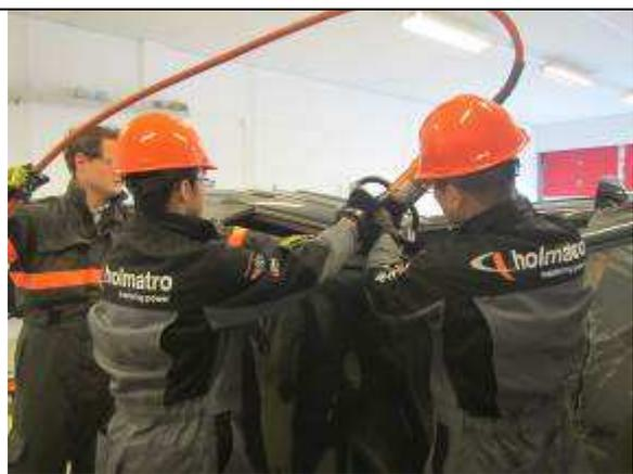
圖 34-24 剪斷上方 A 柱。
