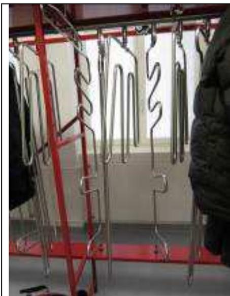
圖 5-1 消防衣架為 IFA 的消防衣帽間設備，遠觀為一排人形鋼管，鋼管直徑約 1 公分，管上有孔，內通熱空氣竄出來以烘乾消防衣褲。
