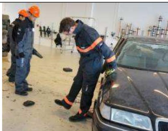
圖 34-4 以後腳跟輕踢固定楔形墊塊。
