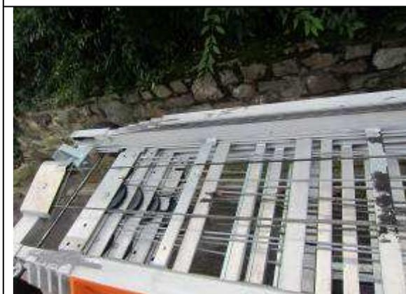
圖 39-5 高空作業車梯子收納情形。
