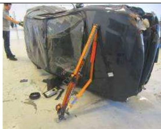
圖 34-2 覆車輛需先固定，圖中為固定用器材。
