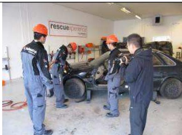
圖 34-8 車輛救援訓練情況用油壓破壞器於前輪上方之位置壓制，以製造縫隙。
