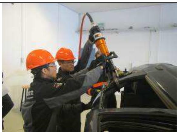
圖 34-22 剪斷上方 C 柱。
