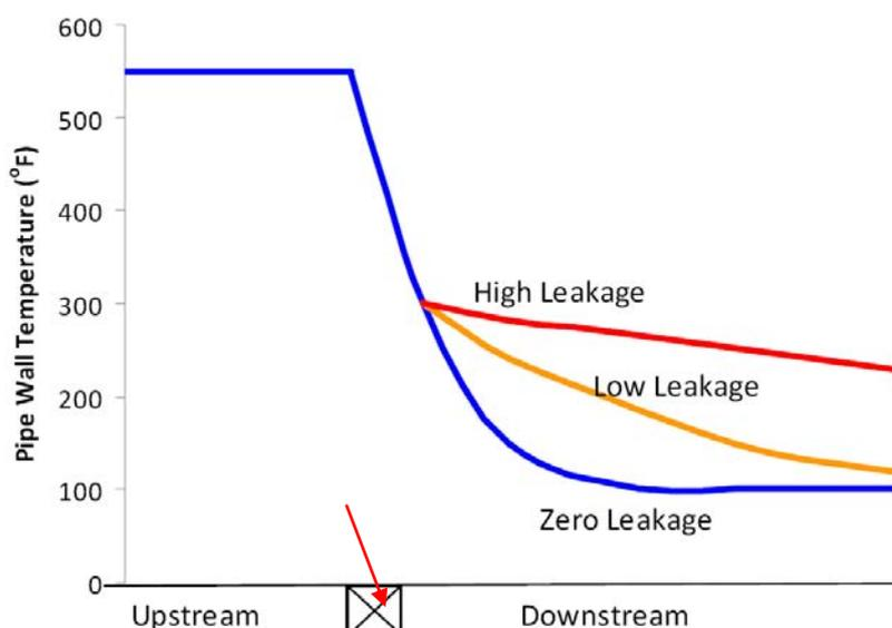
圖 13 以閥件上下游溫度判斷洩漏程度之示意圖
