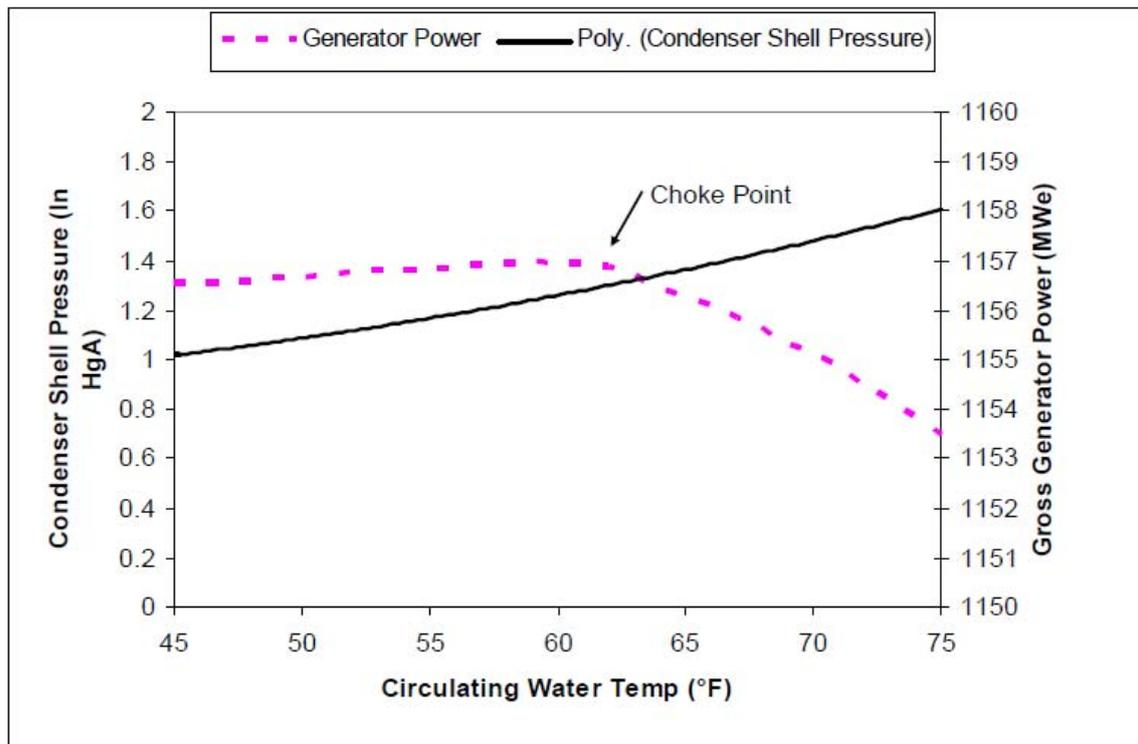
圖8 循環海水溫度對於冷凝器壓力與電力輸出之關係
