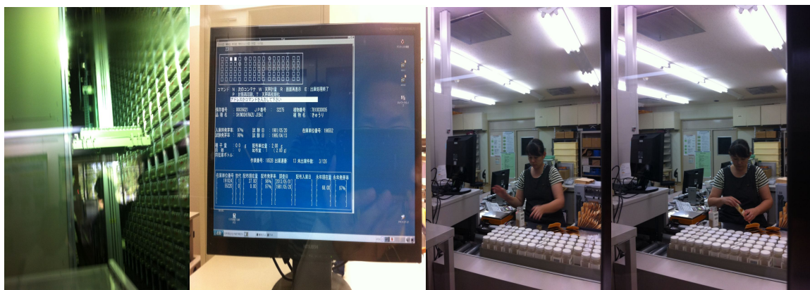
圖 9. 農業科學研究所基因庫之種子庫 (-1°C, 30%RH 長期保存) 以機械化、資訊化模式管理，作業人員透過終端機閱覽種子庫存資訊，藉由電腦操作機械手臂自] 貯存庫揀取活力測試所需之種子，進行稱重、分裝及外袋之印刷標示。
