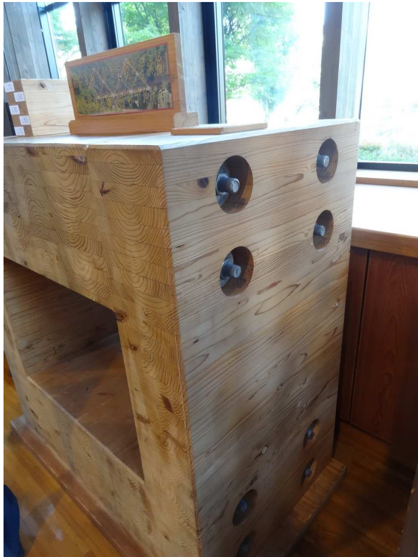
照片 20：宮崎縣木材利用技術中心研發橋樑結構用柳杉集成材框架。
