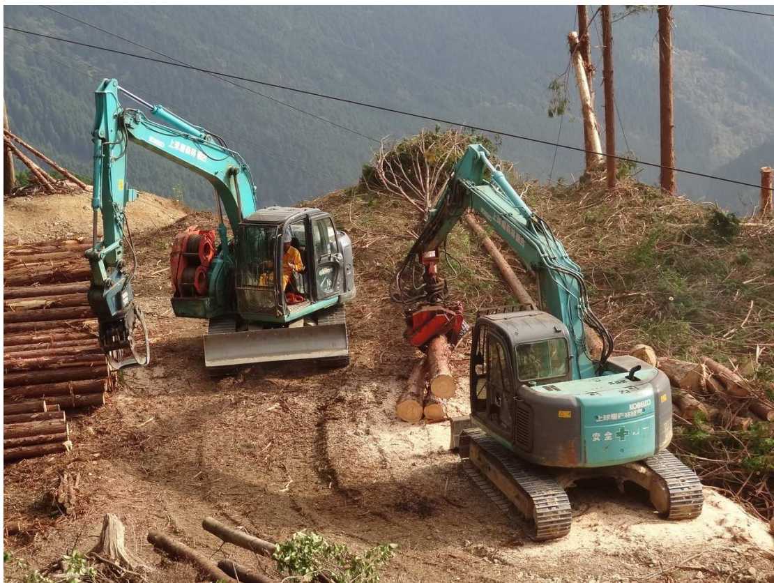
照片 14：熊本縣上球磨地區自走式高性能集材與造材機械運作現況。
