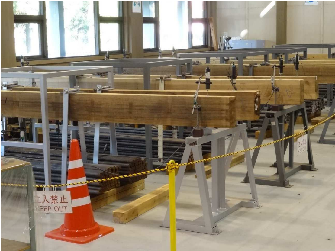
照片 21：宮崎縣木材利用技術中心進行大型柱材應力潛變試驗。
