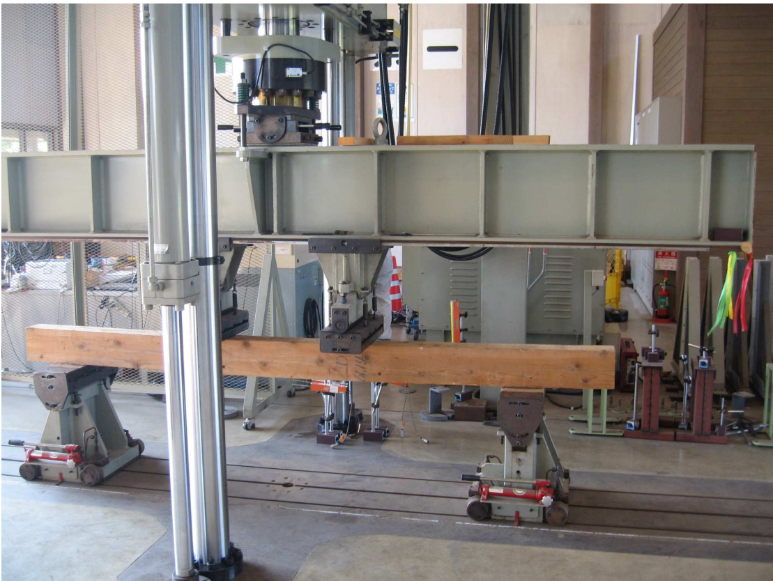
照片 22：宮崎縣木材利用技術中心進行實木大樑抗彎強度試驗。
